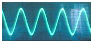
(d) Output voltage of LC Resonant Inverter.
