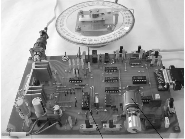
L298N DUAL H-BRIDGE DRIVER L297 STEPPER MOTOR CONTROLLER
